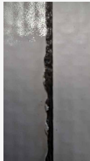
Zu heiss geschweisst: braune Verfärbung und Schlackenbildung bei PVC-Dichtungsbahnen
