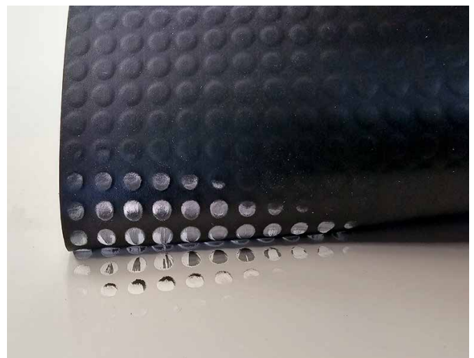
Ungenügender Anpressdruck: Die Noppen sind nicht genügend verschmolzen.
