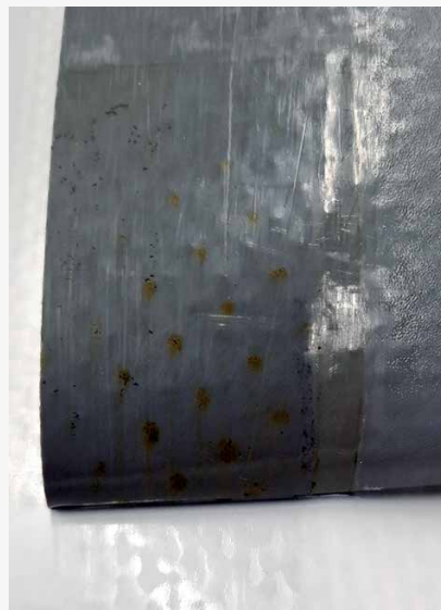
Zu heiss geschweisst: braune Verfärbung und Schlackenbildung bei PVC-Dichtungsbahnen
