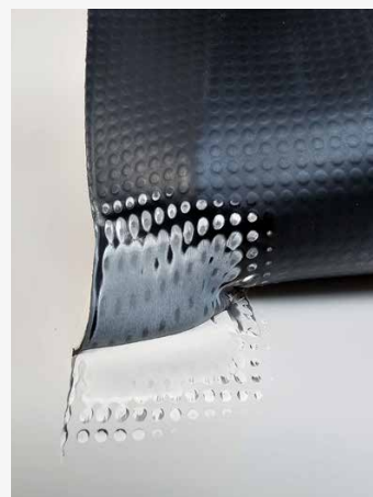
Zu heiss geschweisst: keine dichte Schweissung bei FPO-Dichtungsbahnen, Moleküle wurden irreparabel zerstört
