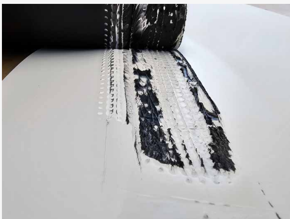
Zu heiss geschweisst: keine dichte Schweissung bei FPO-Dichtungsbahnen, Moleküle wurden irreparabel zerstört
